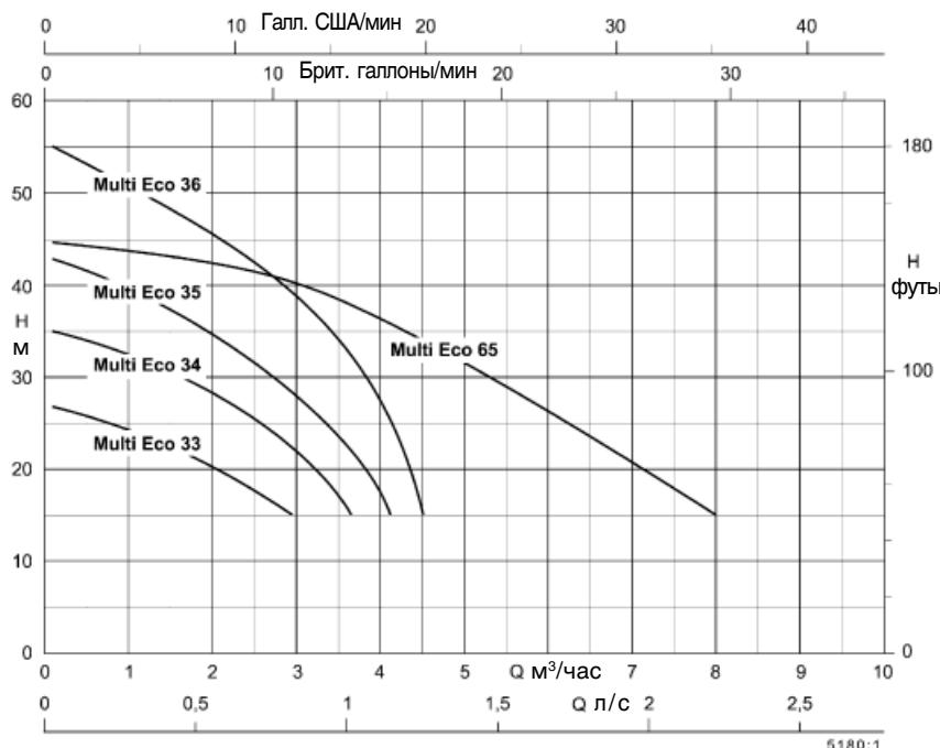
Напор является суммой высоты всасывания + напор перекачивания + сопротивление во всасывающем и напорном трубопроводах + остаточное давление. Подача насоса зависит от развиваемого ею напора. Максимальная высота всасывания для всех типоразмеров около 8 м.
