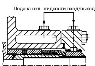
Торцовое уплотнение одинарного действия, интенсивно охлаждаемое с опорным кольцом системы охлаждения
